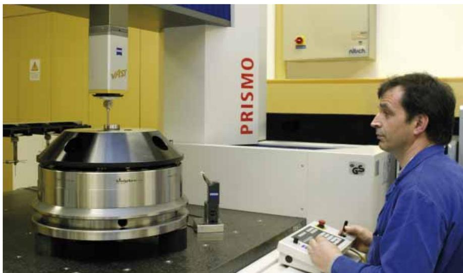
*Un mandrino Königdorn® destinato alla produzione di motori aeronautici al collaudo finale: una macchina di misura ad elevata precisione controlla la concentricità.*
