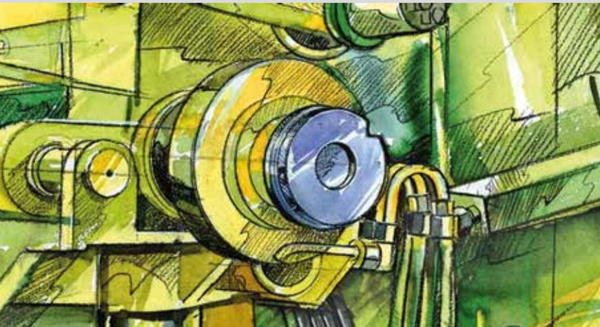
**La versatilità del dispositivo ha portato alla introduzione di un meccanismo di resettaggio idraulico, che lo rende più semplice e sicuro nell'utilizzo, per esempio nelle applicazioni dove non c'è un dispositivo di bloccaggio dell'albero.**
