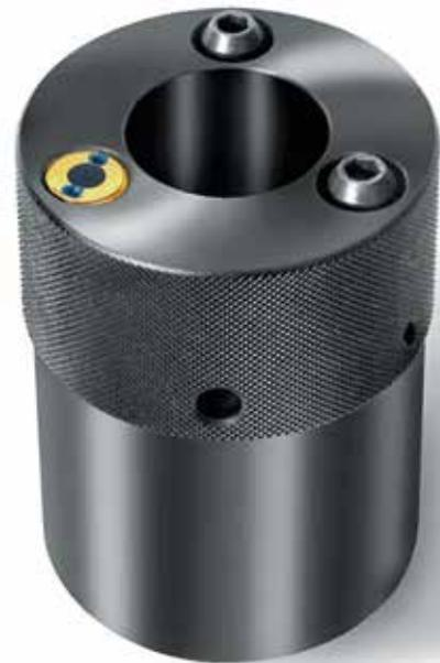
La superficie di bloccaggio, azionata idraulicamente, è flottante e si adatta alla superficie da stringere con una forza decisa, definita ed assiale. Il valore della effettiva forza assiale è regolato e monitorato dall'indicatore di pressione a stadi. qualora necessario, è possibile modificare in fabbrica la calibrazione della pressione di bloccaggio.
