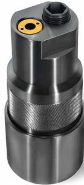
Il sistema idraulico incorporato è azionato avvitando la vite di comando all'estremità dello stesso usando la chiave di corredo. Il valore della forza assiale effettiva è regolato e monitorato dall'indicatore della pressione di bloccaggio a due stadi. I pezzi da assemblare sono stretti insieme dalla spinta esclusivamente assiale del pistone idraulico.
